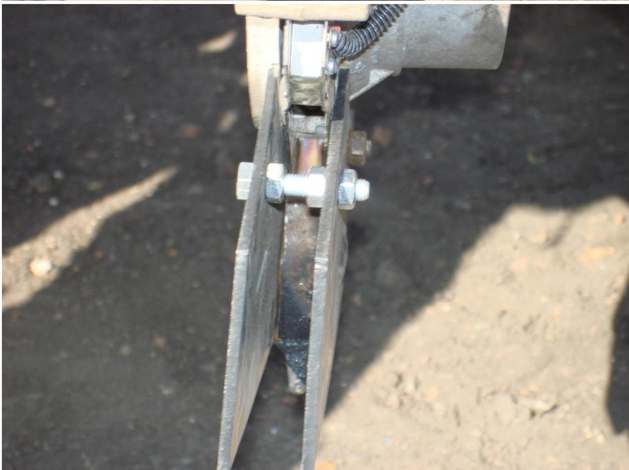
Гайками выставить зазор порядка 1...2мм между стенками сошника и корпусом датчика
