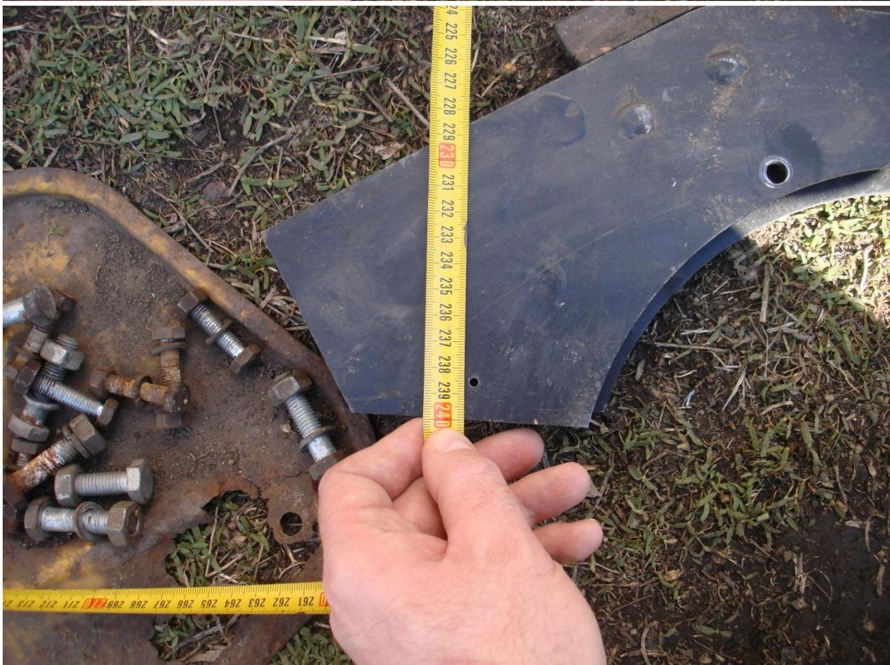
Просверлить сквозные отверстия малого диаметра с одной стороны сошника через две стенки, по размеру как показано. Затем рассверлить отверстия для установки болта М8.
